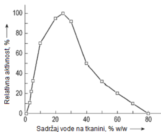
Slika 3.7. Relativna aktivnost enzima u toku sušenja tkanine nakon pranja pod evropskim standardima i jednostepenim ispiranjem česmenskom vodom 14
