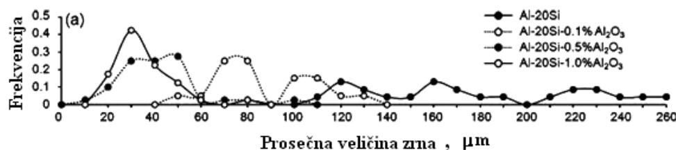
Slika 11. Rafinacija primarnih silicijumovih čestica u leguri AlSi20 korišćenjem \text{Al}_2\text{O}_3 nano čestica [65]
