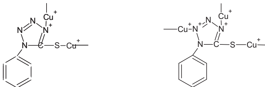
Slika 9. Struktura Cu-PMT zaštitnog filma
