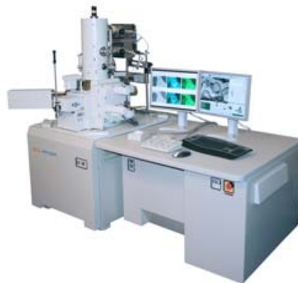
Слика 3.9 Сканирајући електронски микроскоп JEOL JSM-6610 LV коришћен у раду (Pulsar, Amplitude Technologies).
