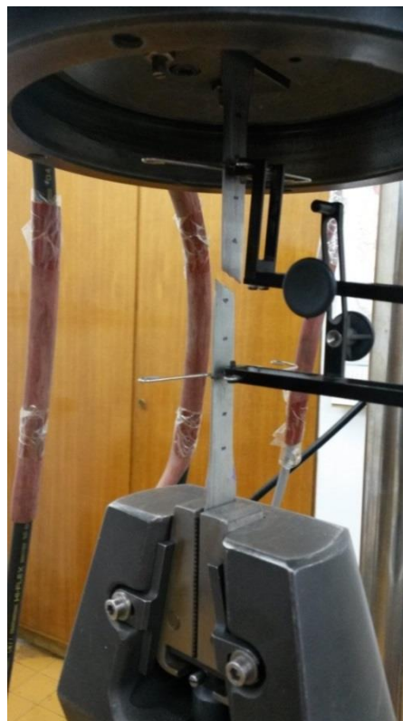
Slika 4.11. Ispitivanje zatezanjem na kidalici
