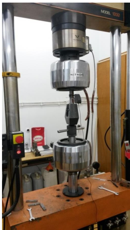
Slika 4.11. Ispitivanje zatezanjem na kidalici
