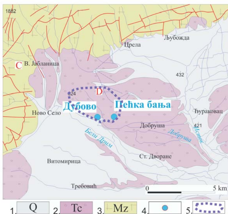
Слика 58. Шематска хидрогеолошка карта области угљокиселих вода Дубова и Пећке бање (геолошка основа по С. Мојсиловић и Д. Баклаић, 1984)
