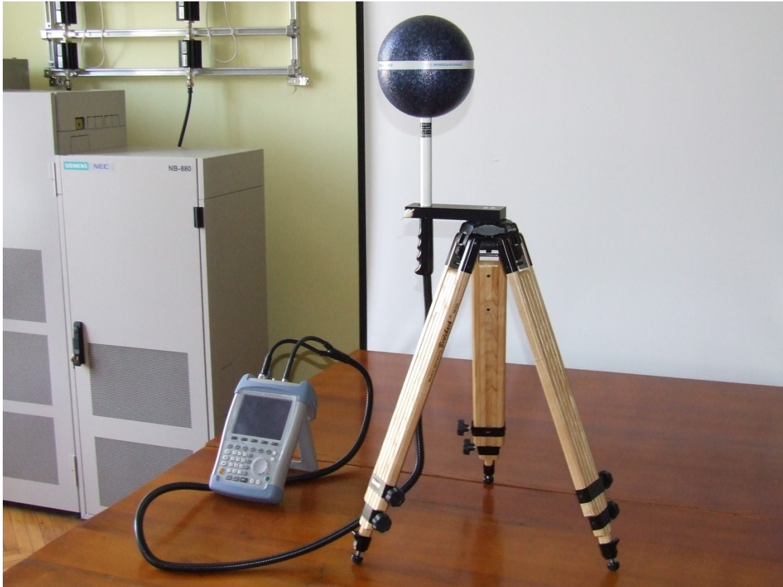
Slika 2.2 Prikaz frekvencijski selektivnog mernog sistema koji se sastoji se od spektralnog analizatora Rohde&Schwarz FSH6 i izotropne merne sonde TS-EMF
