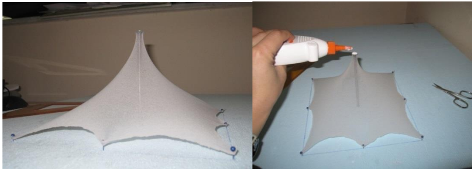
Слике 55а и 55б – фиксирање потпорне тачке једноставног мембранског крова (извор: аутор)
