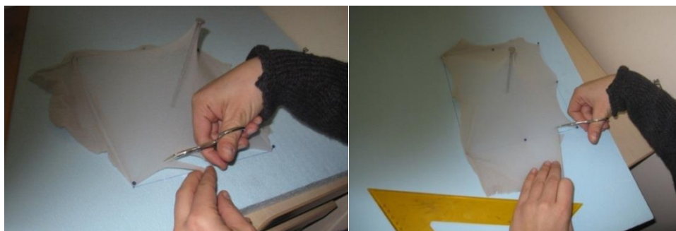
Слике 54а и 54б – опсецање мембране једноставног мембранског крова (извор: аутор)
