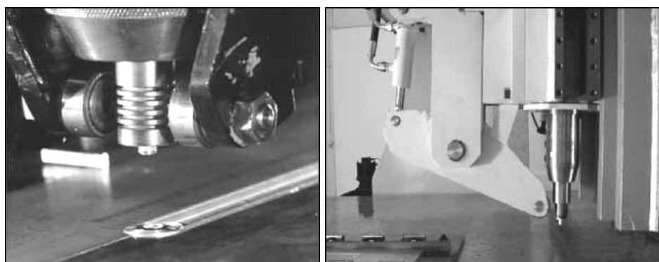
Слика 2-26. Механички (лево) и хидраулични (десно) систем подешавања и контроле положаја ваљка алата [53].
