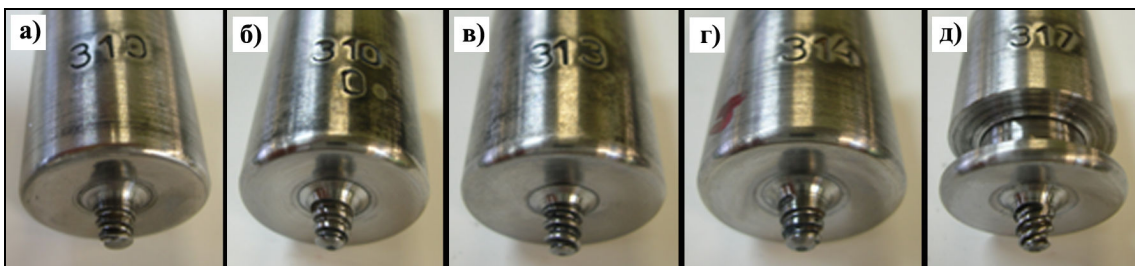
Слика 3-5. Изглед алата израђених од челика \check{C} .5742.
