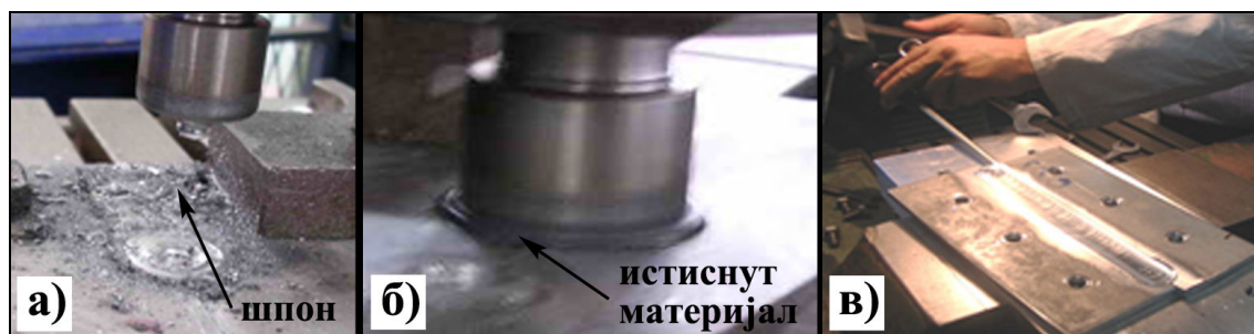
Слика 4-5. Карактеристични процесни проблеми прве фазе заваривања: а) избацивање шпона при пенетрацији трна алата; б) истискивање омекшаног материјала; в) „лепљење“ завареног узорка за потпорну плочу.
