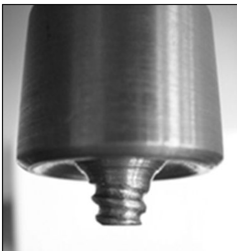
Слика 4-6. Изглед алата А3 са конусним трном и профилисаним челом ваљка.
