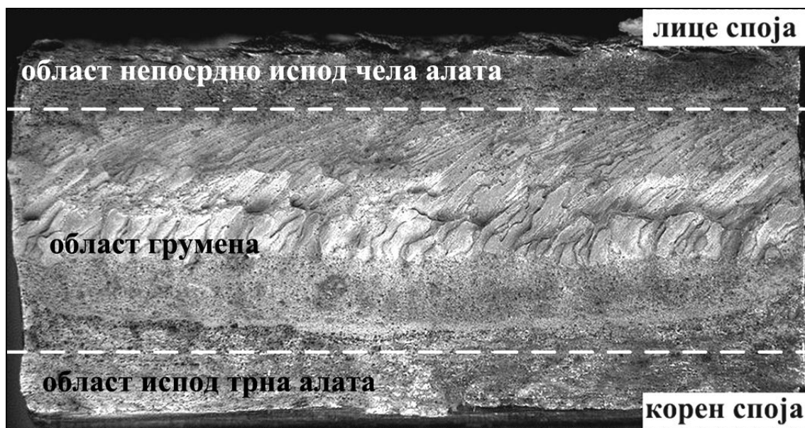
Слика 4-46. Преломна површина затезне епрувете ( V_{rot}/V_{zav} = 750/93 = 8,06 ).
