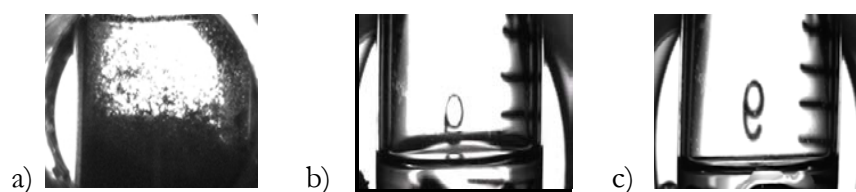
Slika 17. Timol u ćeliji za posmatranje a) pre uvođenja CO 2 u sistem, b) nakon 2 h i c) nakon 6 h na 40 °C i 10 MPa
