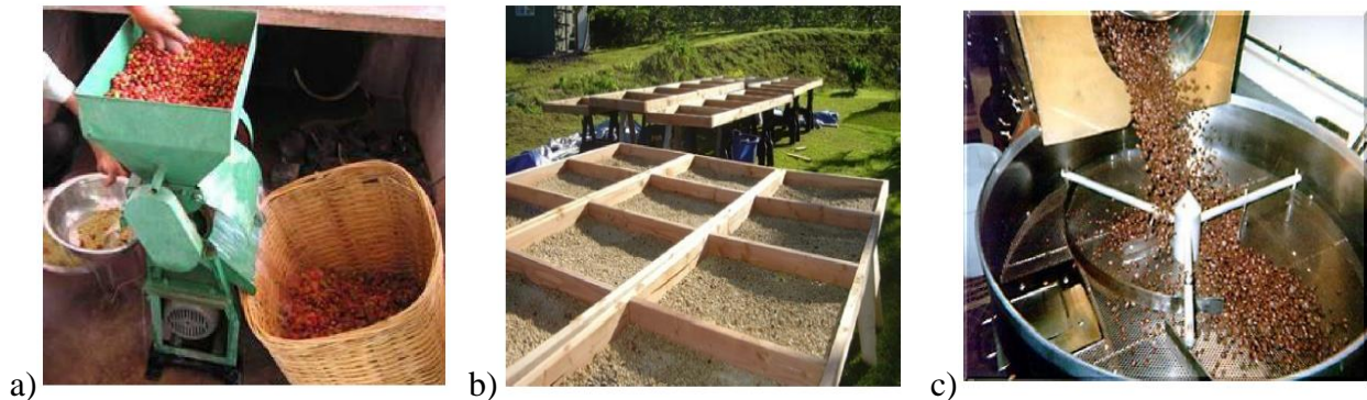
Slika 1.4. Prerada ploda kafe: izdvajanje pulpe (a), sušenje nakon vlažne obrade (b) i pečenje kafe (c) [5]
