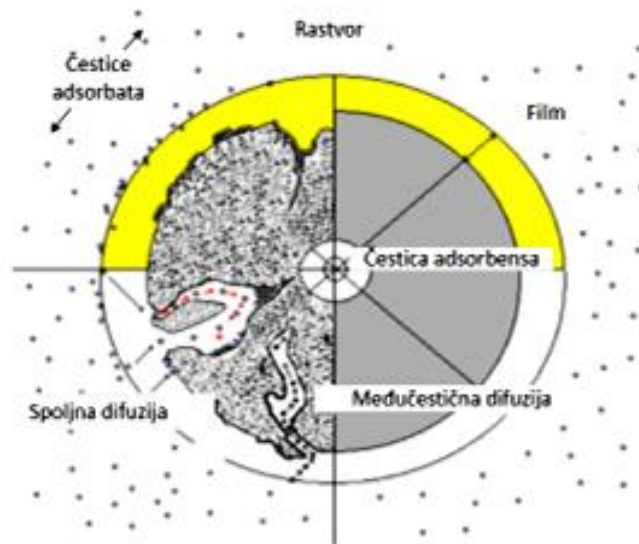
Slika 5.3. Spoljašnja i unutrašnja difuzija čestica adsorbata na poroznim adsorbentima [178]
