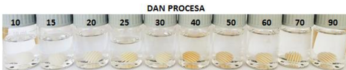
Slika 8.31. Uzorci nosača izvađeni iz kolone određenog dana procesa. Promena boje nosača je u vezi sa količinom imobilisane biomase
