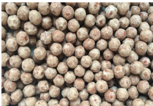
Slika 7.3. Keramičke kuglice sa formiranim biofilmom
