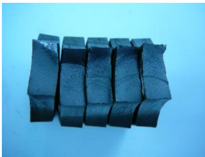
Slika 6.3. Izgled prelomnih površina epruveta iz eksperimenta zamaranjem na visokofrekventnom pulzatoru Amsler
