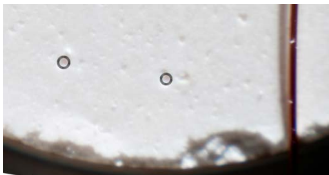
Slika 3.3. Fotografija površine mete nakon ozračavanja laserskim impulsom. Na slici su obeleženi krateri koje je izazvao laserski impuls. Izmeren prečnik kratera je 200 \mu\text{m} . Tanka bakarna žica prečnika 150 \mu\text{m} koja je na slici prikazana sa desne strane služi kao referenca.
