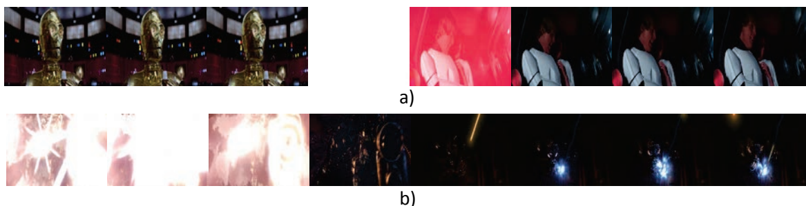
Slika 6.6. Ispušteni kadrovi u procesu detekcije: a) usled promene osvetljenja celog frejma i ubacivanja veštačkih frejmova, b) usled specijalnog efekta unutar kadra.
