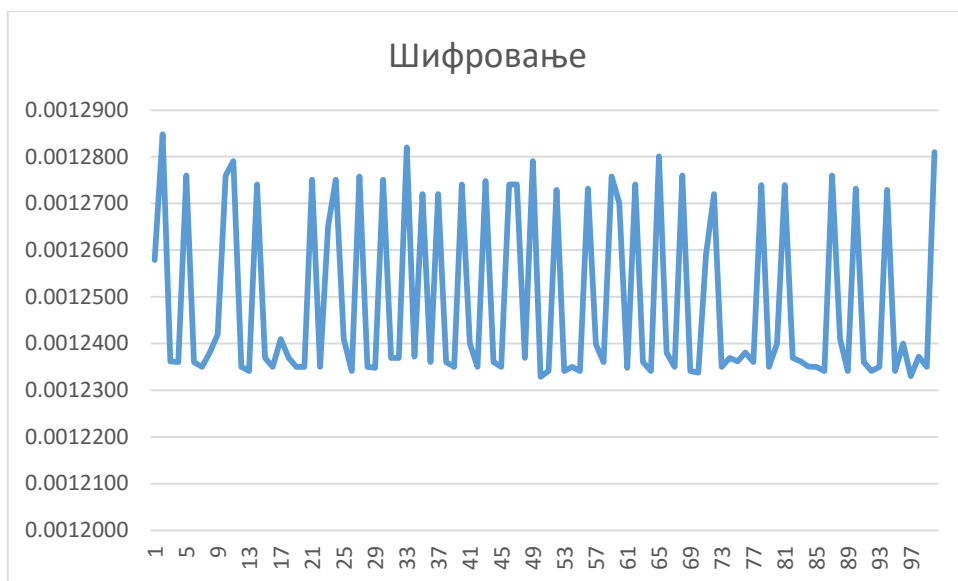
Слика 71. Време извршавања скрипте заштићене шифровањем кода решењем SourceGuardian
