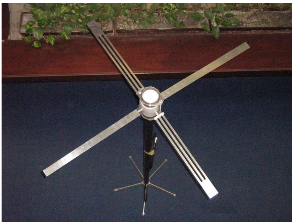
Slika 6.23. Fotografija realizovane turnstile antene montirane na vertikalni stub - nosač.
