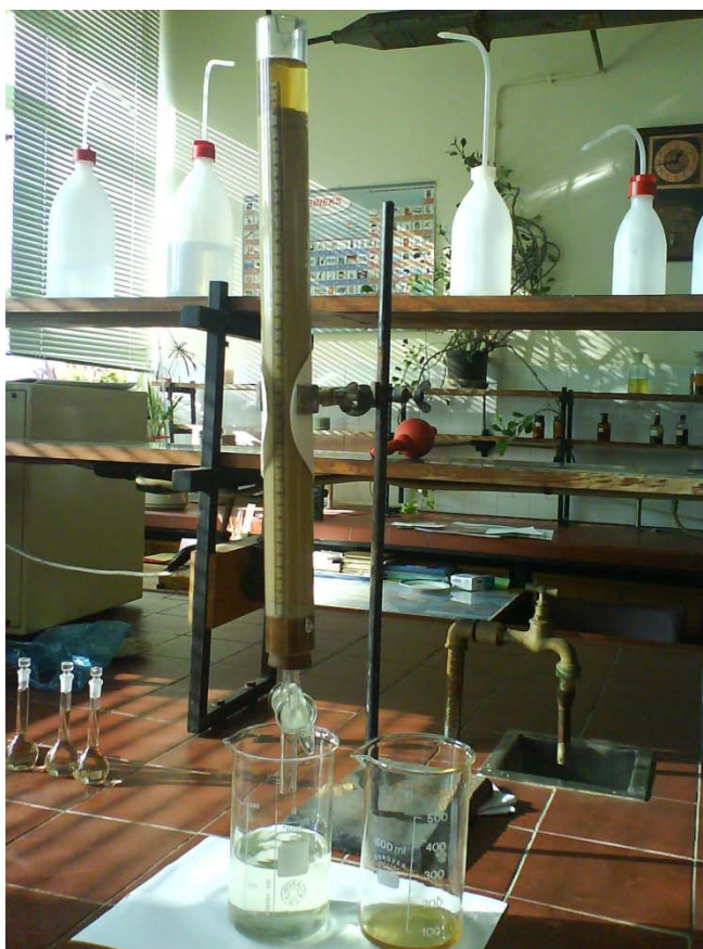
Slika 3. Adsorpciona kolona: prečnik kolone 32 mm; visina kolone 500 mm; visina sloja slame u koloni 400 mm; protok vodene faze 10 \text{ ml min}^{-1}
