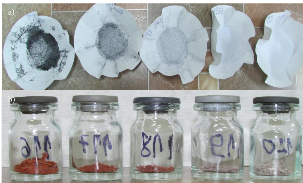
Slika 4.9. Proizvodi pene pri pH 3 i koncentraciji oleinske kiseline 2,03 \cdot 10^{-4} \text{ M/dm}^3 : a) formirani laboratorijski list nakon filtriranja proizvoda pene nakon 1, 2, 4, 6, 10 minuta flotiranja (slevo na desno), b) pepeo nakon spaljivanja proizvoda pene
