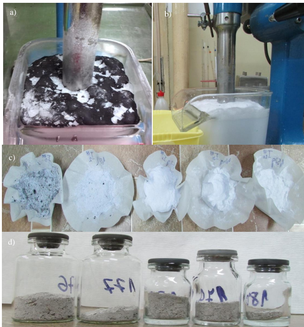
Slika 4.7. Stabilan sloj pene pri flotiranju tonera pri pH 9 i koncentraciji oleinske kiseline 2,03 \cdot 10^{-4} M/dm 3 : a) pogled odozgo nakon 1. minuta flotiranja, b) pogled sa strane nakon 6. minuta flotiranja, c) formirani laboratorijski list nakon filtriranja proizvoda pene nakon 1, 2, 4, 6, 10 minuta flotiranja (sleva na desno), d) pepeo nakon spaljivanja proizvoda pene
