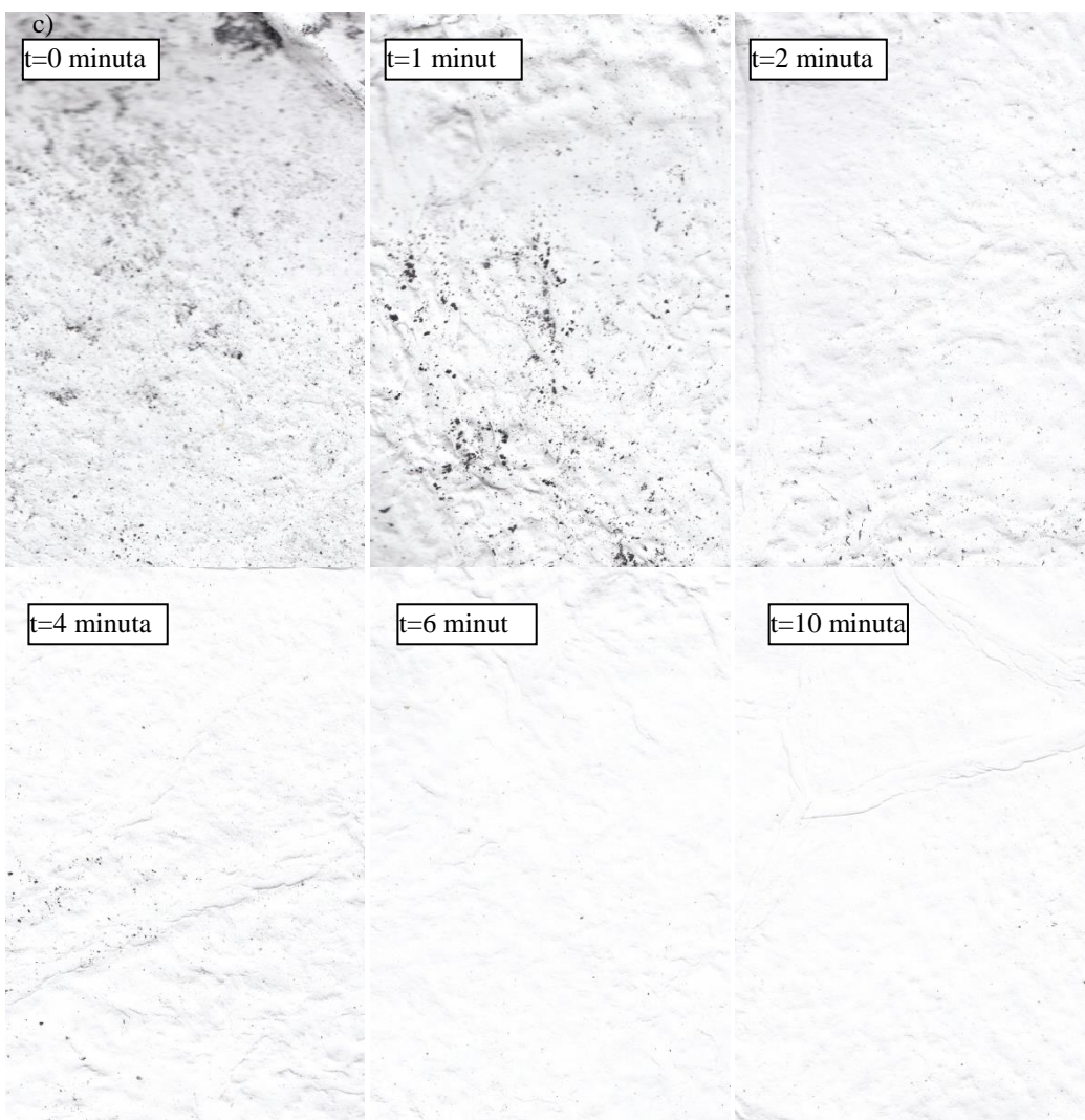
Slika 4.19. Proizvodi pene pri pH 9 i koncentraciji MIBC 1,40 \cdot 10^{-5} \text{ M/dm}^3 a) formirani laboratorijski list nakon filtriranja proizvoda pene nakon 1, 2, 4, 6, 10 minuta flotiranja (slevo na desno), b) pepeo nakon spaljivanja proizvoda pene, c) formirani laboratorijski list nakon filtriranja proizvoda otoka nakon 0, 1, 2, 4, 6, 10 minuta flotiranja
