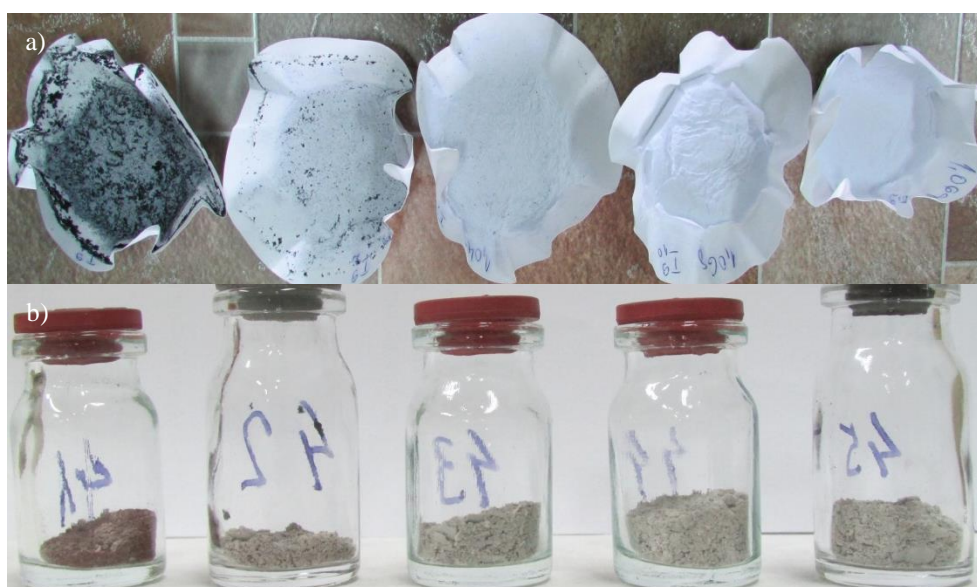
Slika 4.17. Flotacija tonera na pH 7 i koncentraciji MIBC 5,60 \cdot 10^{-5} \text{ M/dm}^3 : a) formirani laboratorijski list nakon filtriranja proizvoda pene nakon 1, 2, 4, 6, 10 minuta flotiranja (slevo na desno), b) pepeo nakon spaljivanja proizvoda pene
