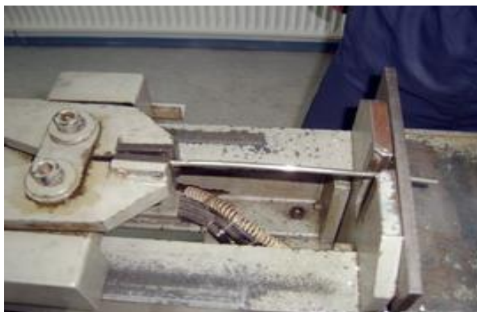
Slika 32. Izvlačenje cevi od zlata na dijamantskoj matrici
