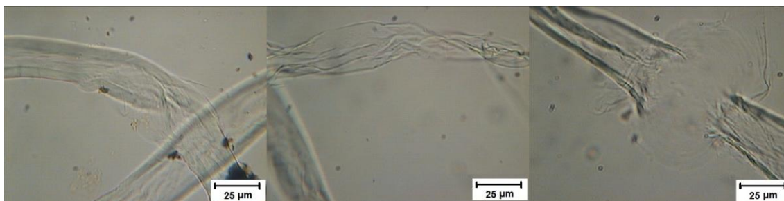
Slika 8.21. Mikrofotografije pamučnih vlakana modifikovanih u O 2 DBD nakon 360 min rastvaranja u DMAc/LiCl 9 % (w/v) pri uveličanju 400x
