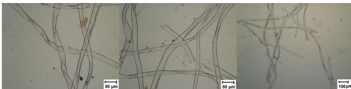
Slika 8.22. Mikrofotografije pamučnih vlakana modifikovanih u O 2 DBD nakon 360 min rastvaranja u DMAc/LiCl 9 % (w/v) pri različitim uveličanjima
