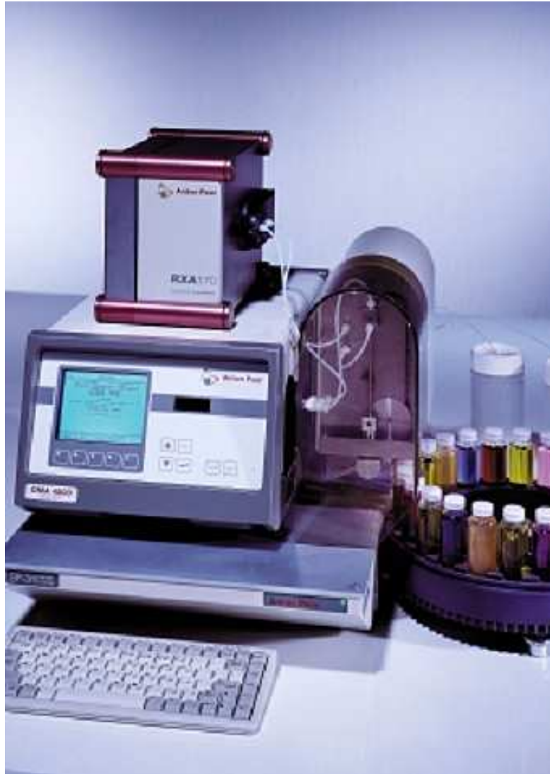
Слика 6.5 Комбиновани систем густиномер Anton Paar DMA 5000 и рефрактометар Anton Paar RXA 156
