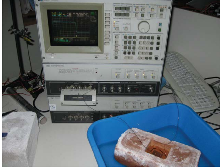
Slika 5.7. Eksperimentalna postavka za merenje koncentracije vlage u opeci od pečene gline korišćenjem LC senzora, antenskog namotaja i instrumenta HP-4194A
