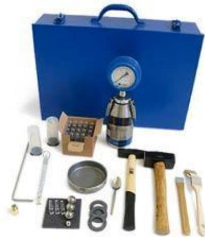
Slika 3.1. Set za merenje vlage pomoću karbidnog merača [37]
