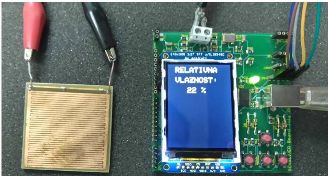
Slika 7.10. Merenje vlage pomoću prenosivog ( handheld ) uređaja i LC senzora
