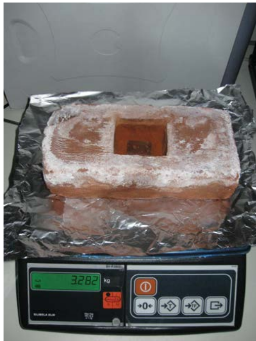
Slika 5.8. Merenje mase opeke od pečene gline preciznom elektronskom vagom
