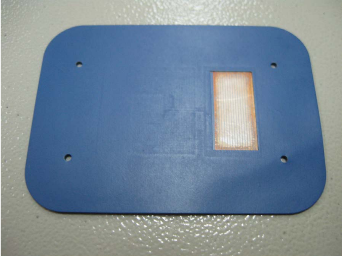
Slika 2.6. Izgled LC senzora tipa #4 izrađenog u LTCC tehnologiji
