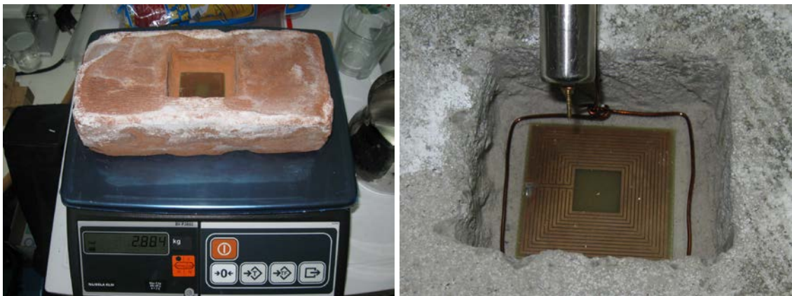
Slika 5.24. Merenje vlage u građevinskoj opeci i YTONG bloku korišćenjem bežičnog LC senzora tipa #3
