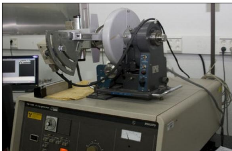
Slika 22. X-Ray difraktometar "PHILIPS", model PW-1710
