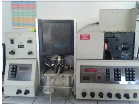
Slika 25. AAS uređaj marke "Perkin Elmer", model 2380 sa plamenom peći
