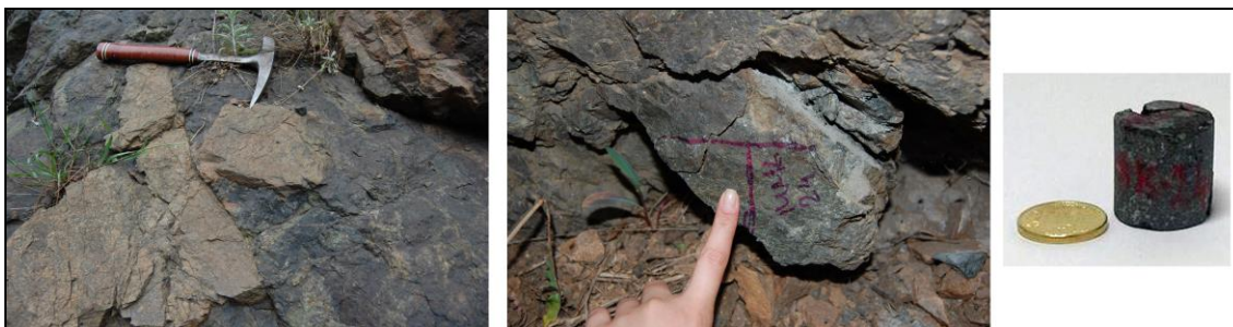
Slika 11. Fotografije uzorka na terenu (levo), orijentisani uzorak (u sredini) i uzorak pripremljen za laboratorijsku analizu (MAK 24 - dijabaz, desno)
