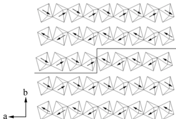
Слика 2.2.7. Структурни модел титанита који приказује ланце [\text{TiO}_6] – октаедра паралелне осе a . Стрелице показују правце померања \text{Ti} (Taylor et Brown , 1976).
