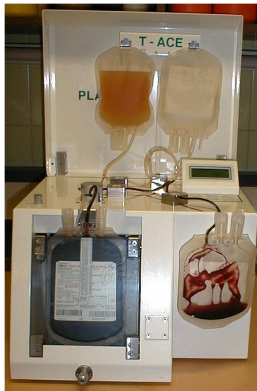
Слика 7. Процесор крвних ћелија, апарат "Т-АЦЕ" (аутоматизовано раздвајање крвних компоненти из јединица целе крви)
