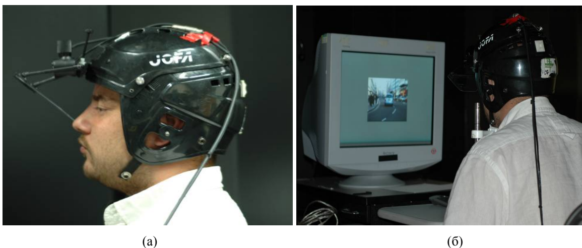
Сл. 6.3 (а) ASL 500 Eye Tracker систем и (б) експериментални услови друге студије у којима је спроведено прикупљање података.
