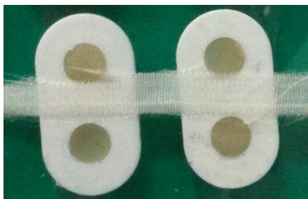
Slika 4. Uzorci materijala u teflonskim kalupima
