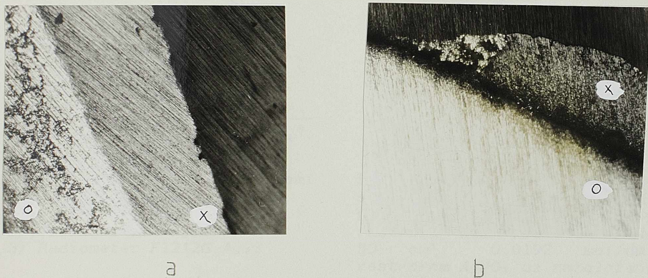
Slika 32. Metalografski snimci nataložene Ag/AgJ/Ag 2 S - D elektrode (uvecanje 110 puta): a) pre upotrebe i b) posle upotrebe u rastvorima cijanida
