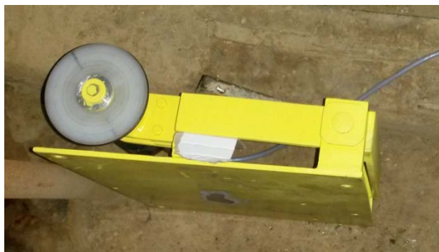
Слика 6.1. Давач броја обртаја прилагодљив разним носачима и монтажи на различитим локацијама
