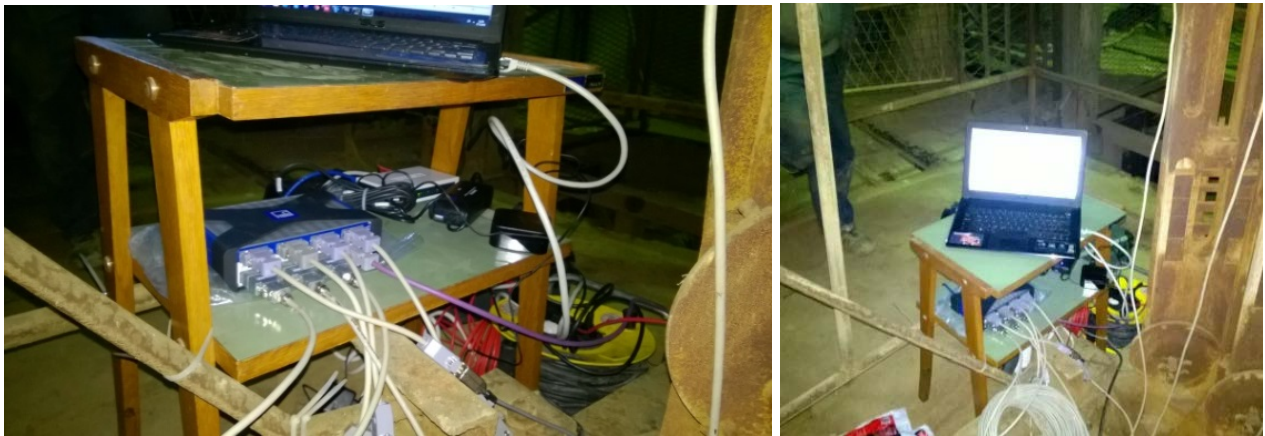
Слика 6.8. Друго осмоканално мерно појачало QUANTUM X MX480B спојено са рачунаром
