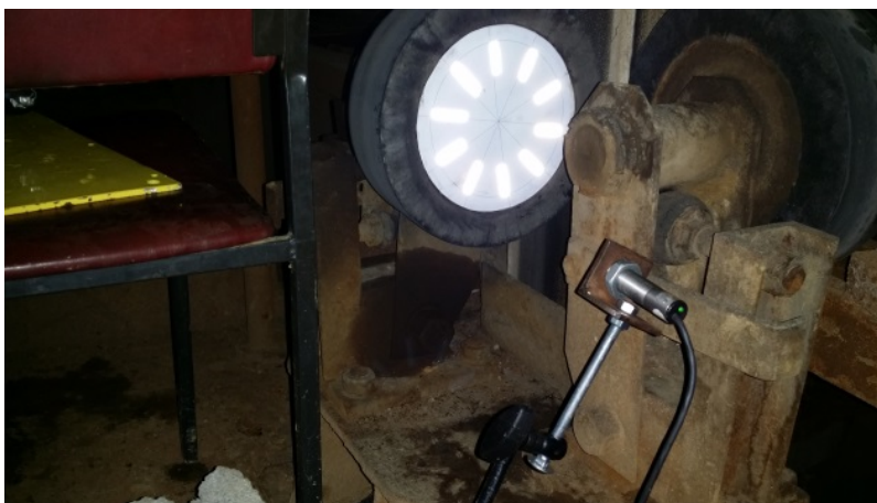
Слика 6.7. Оптички сензор – давач броја обртаја ROS-P, фиксиран на кошу
