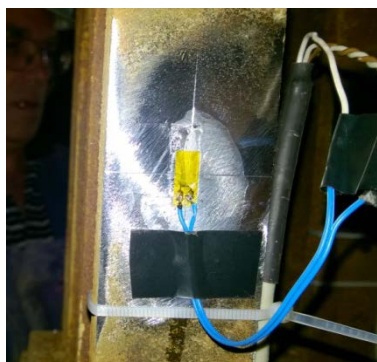
Слика 6.10. Мерење деформација на спојном прибору
