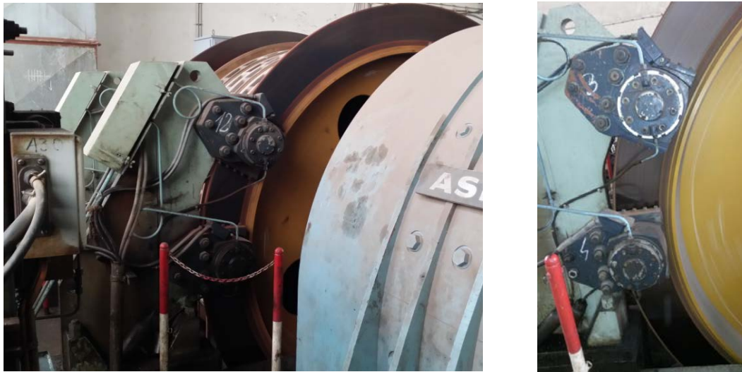
Слика 6.2. Кочиони систем у оквиру погонског механизма извозне машине рудника „Јама“ РТБ Бор
