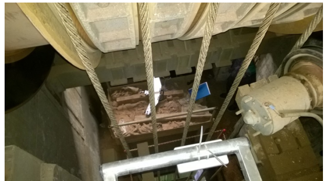
Слика 6.6. Инкрементални енкодер спојен са мерним точком постављеним на венац кочионог диска (а); мерно појачало QUANTUM X MX480В (б); радио антене NanoStation loco NS2L (в)
