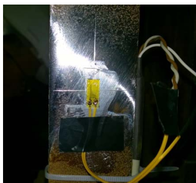
Слика 6.10. Мерење деформација на спојном прибору
