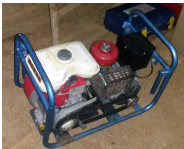
Слика 6.11. Бензински агрегат за напајање мерног уређаја електричном енергијом
