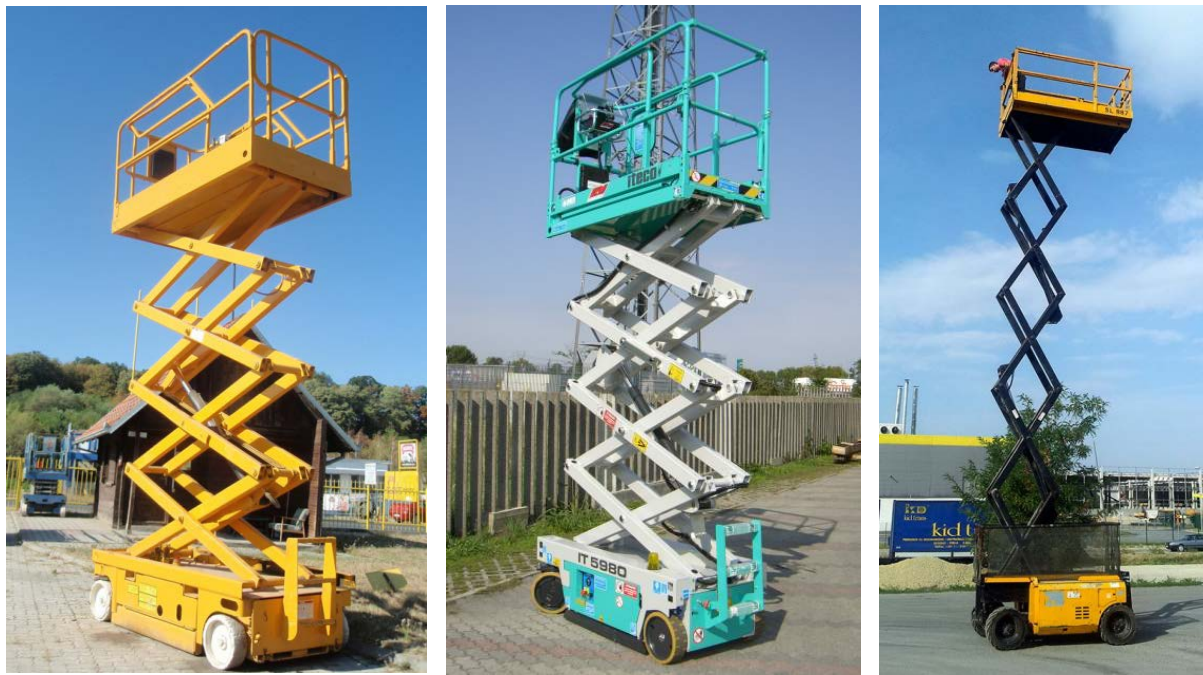
Слика 1.11. Подизна радна платформа са макастим механизмом дизања
