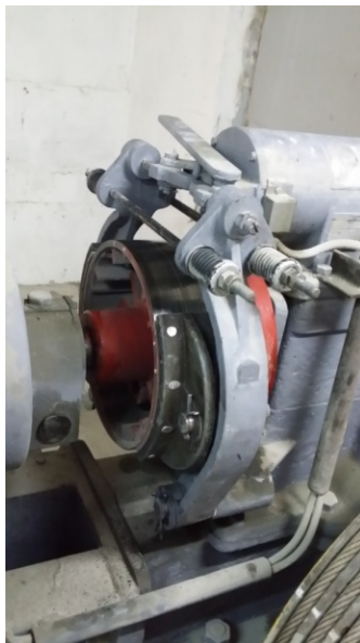
Слика 2.28. Кочница са ручицом за откочивање (а) и део опреме за мерење (б)
