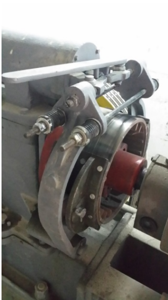
Слика 2.28. Кочница са ручицом за откочивање (а) и део опреме за мерење (б)
