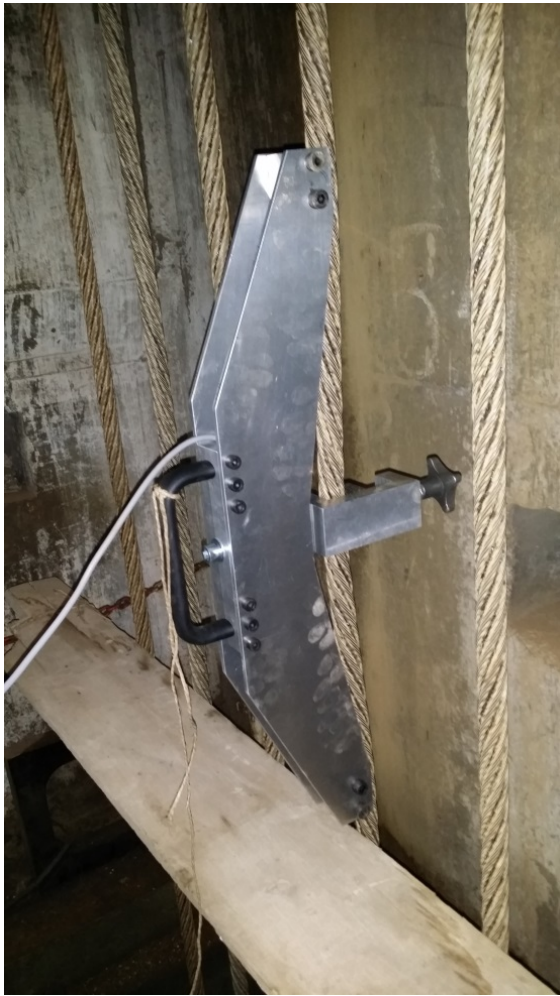
Слика 6.12. Мерење силе у ужадима са дигиталним читавањем
