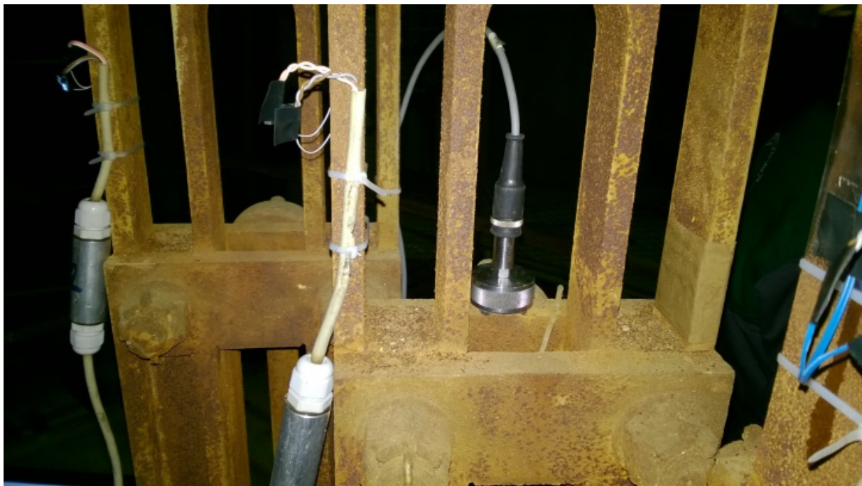
Слика 6.9. Мерење убрзања на спојном прибору коша
