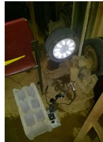
Слика 6.7. Оптички сензор – давач броја обртаја ROS-P, фиксиран на кошу
