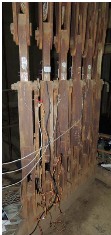
Слика 6.3. Спојни прибор за везу носећих ужади са кошом (кабином)
