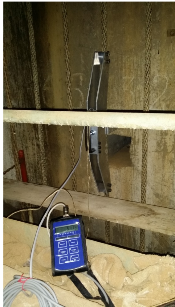
Слика 6.12. Мерење силе у ужадима са дигиталним читавањем
