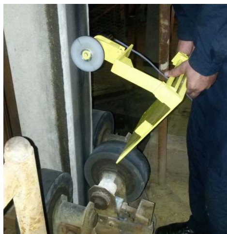
Слика 6.1. Давач броја обртаја прилагодљив разним носачима и монтажи на различитим локацијама
