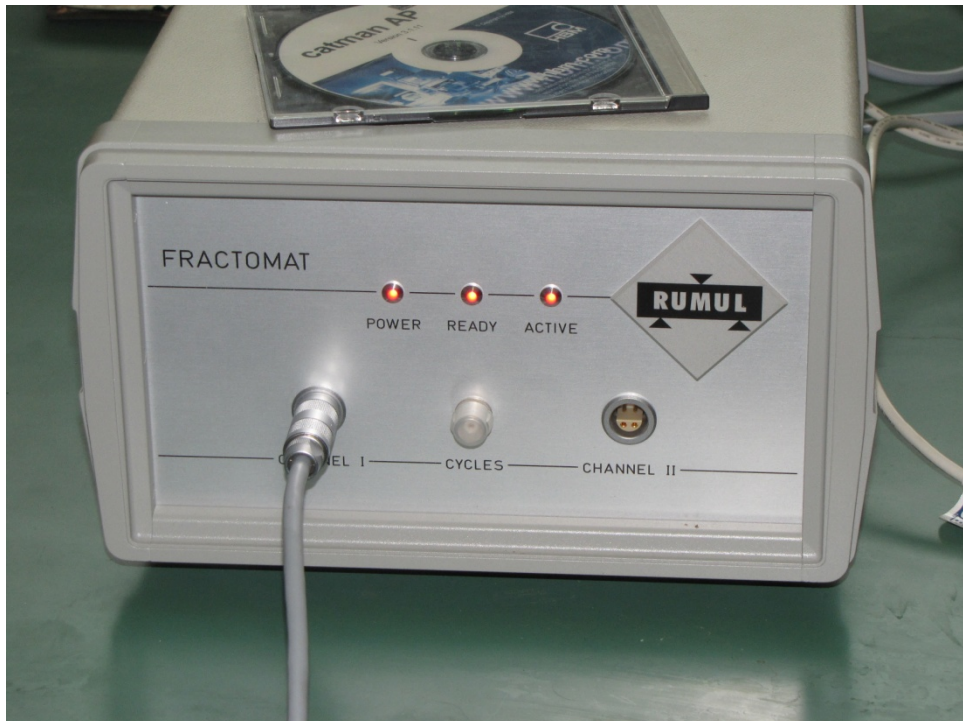
Сл. 8.4 Уређај FRAC TOMAT за регистрацију зависности a-N
