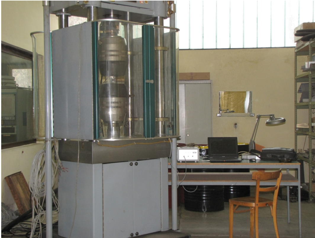
Сл. 8.3 Сервохидраулични систем МТС којим је уведено циклично оптерећење структуралног елемента
