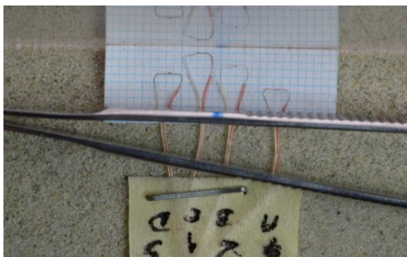
Slika 38: a) Primer pozicioniranja termoparova kalupa; b) Primer pozicioniranja termopara u odlivku.
