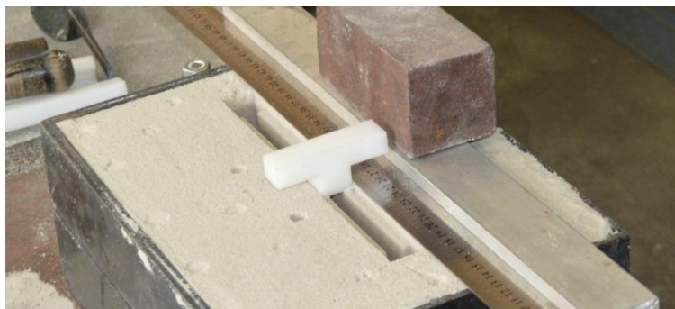
Slika 92: Izrada proširenja na vrhu kalupa pomoću šablona.
