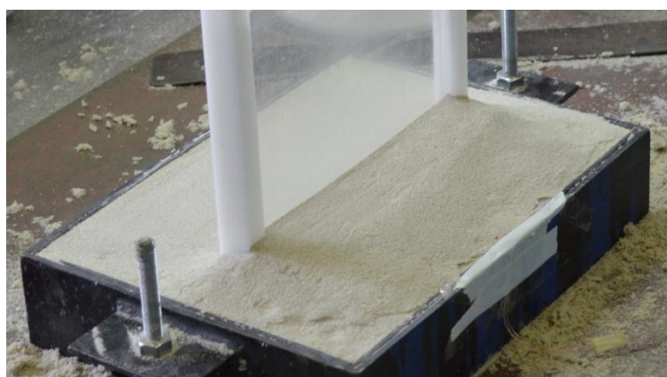
Slika 91: Izgled kalupa nakon završetka izrade podeone ravni.
