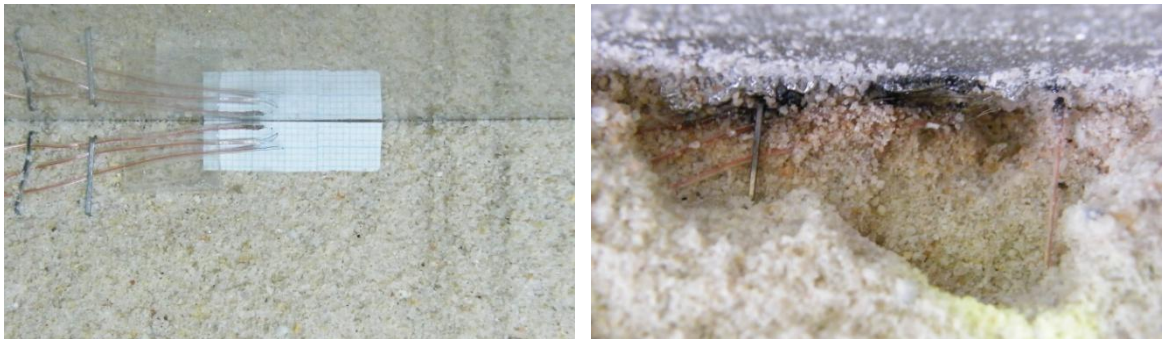
Slika 40: Pokušaj paralelnog postavljanja termoparova pri kalupovanju
