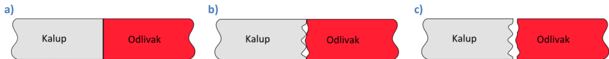
Slika 5: Tri osnovna stanja međupovršine: a) usaglašeni kontakt; b) neusaglašeni kontakt, c) zazor.
