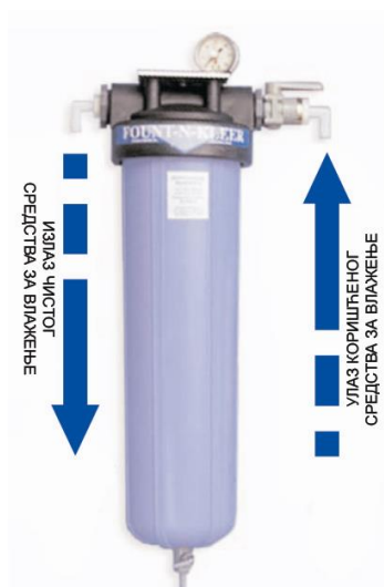
Слика 18. Систем за регенерацију са двостепеном филтрацијом (Prisco, 2009; Kiurski et al., 2010b)
