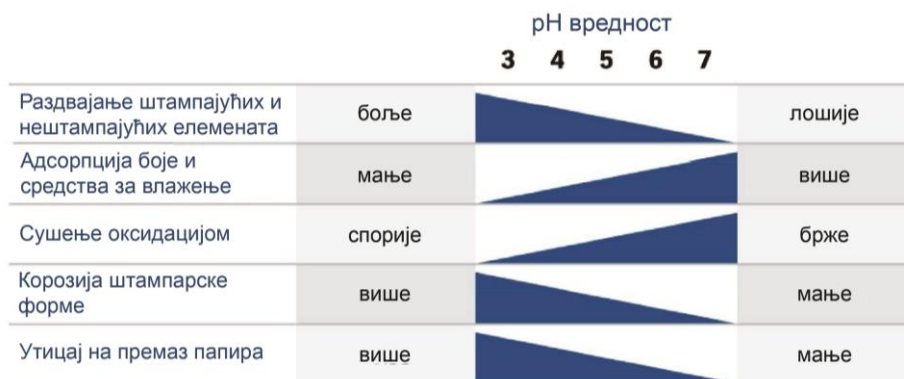
Слика 9. Утицај pH вредности средства за влажење на штампарску форму и квалитет штампе (Hartmann, 2005)
