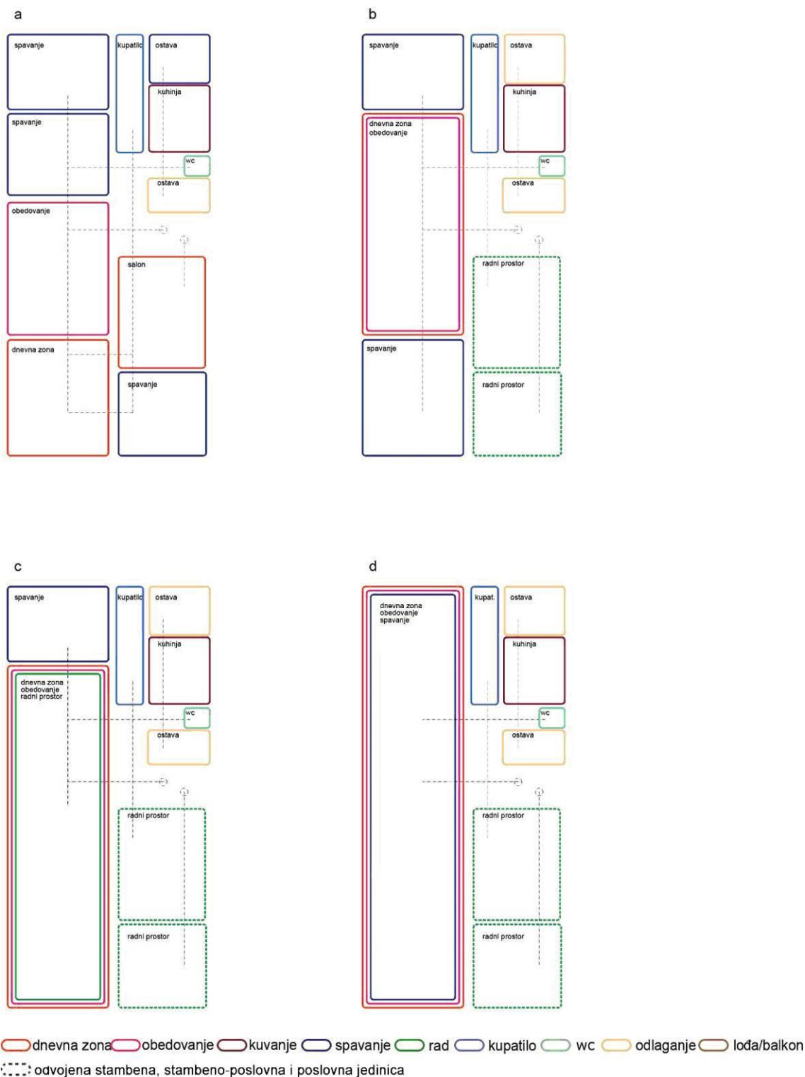
Shema 3. Različita funkcionalna rešenja velikog ugaonog stana od 140m 2 u Tanurdžičevoj palati na piano nobile etaži, projekat arh. Đorđa Tabakovića, iz 1936. godine, Novi Sad.
