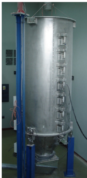
Sl. 205 Foto snimak ispitnog silosa (Couto, Ruiz i Aguado (2013) [53]).
