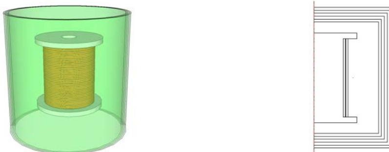
Slika 3.18 Merni transformator oklopljen višeslojnim cilindričnim oklopom (levo) i prikaz njegovog osno simetričnog preseka (desno)
