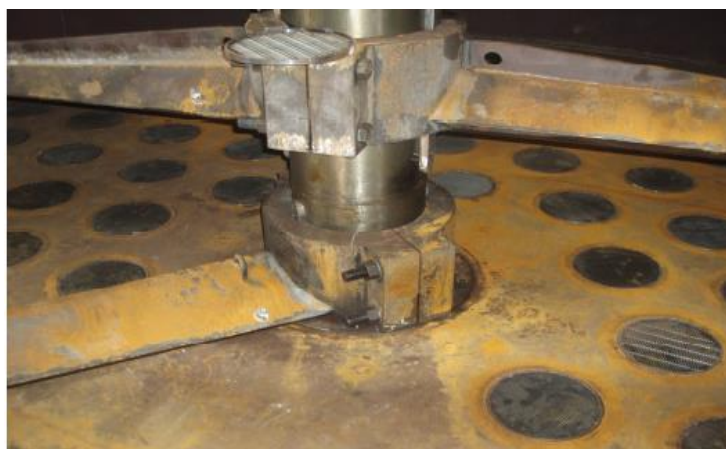
Slika 37. Sita i krak za mešanje u podu za stripovanje
