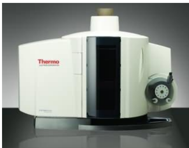
Slika 3.3. Optički emisioni spektrofotometar sa induktivno kuplovanom plazmom (laboratorija Katedre za analitičku i fizičku hemiju Prirodno-matematičkog fakulteta Univerziteta u Nišu).
