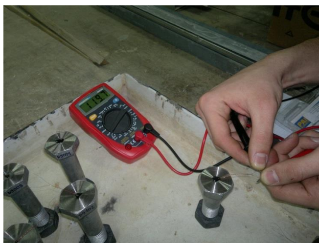
Slika 3.33: Kontrola otpornosti mernih traka nakon postupka očvršćavanja lepka
