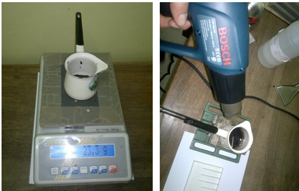
Slika 3.27: Primena digitalne vage i ručnog fena u postupku pripreme lepka
