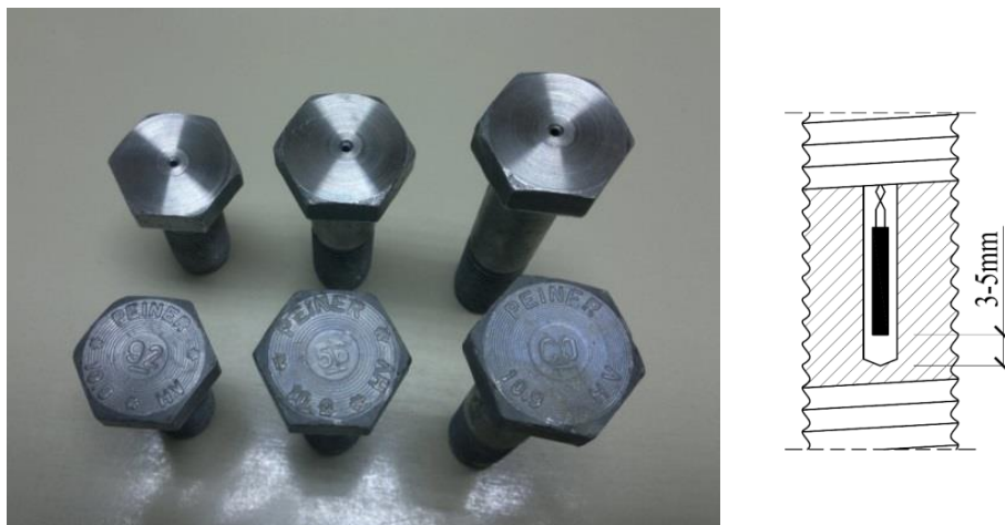
Slika 3.21: Zavrtnjevi sa izbušenim rupama za ugradnju merne trake i položaj merne trake u odnosu na dno rupe
