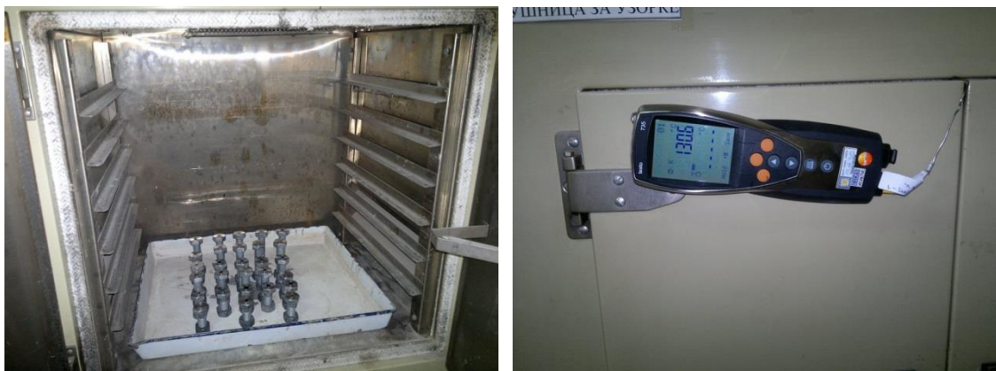
Slika 3.32: Zavrtnjevi pripremljeni za termički tretman lepka u laboratorijskoj sušnici sa temperaturom kontrolisanom uz pomoć temperaturne sonde
