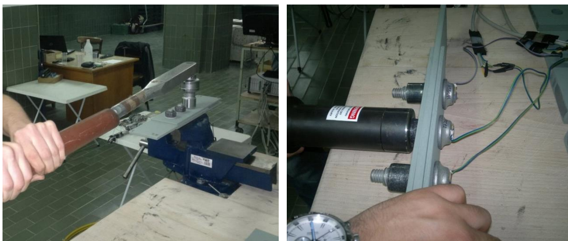
Slika 3.47: Ugradnja zavrtnjeva u uzorke
