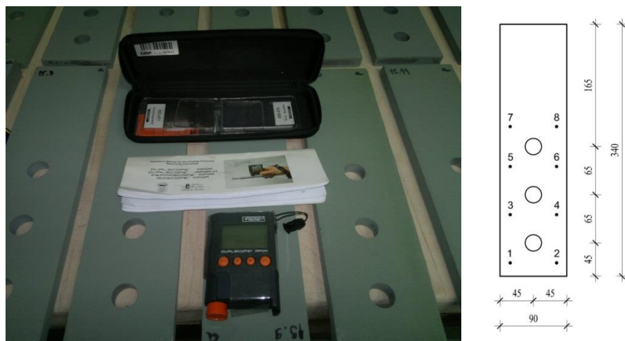
Slika 3.18: Laboratorijski elkometar proizvođača „Fischer“ i raspored mernih mesta za određivanje debljine premaza
