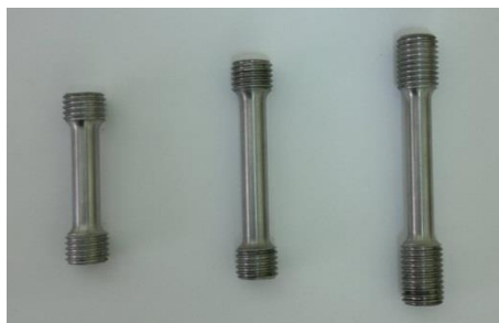
Slika 3.3: Epruvete za određivanje fizičko mehaničkih osobina HV zavrtnjeva
