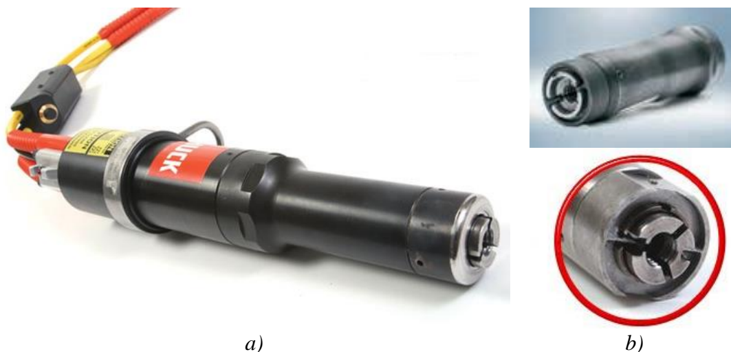
Slika 2.6: a) Presa sa glavom za ugradnju HBT zavrtnjeva, b) glava za demontažu HBT zavrtnjeva
