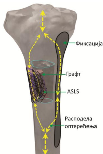
Слика 70. Имплантатни склоп (расподела оптерећења се може контролисати обликом попречног пресека и просторним распоредом гредица ( ASLS ))
