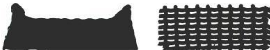
Слика 91. а) скафолд израђен коришћењем ваздуха као медијума; б) скафолд израђен коришћењем воде као медијума
