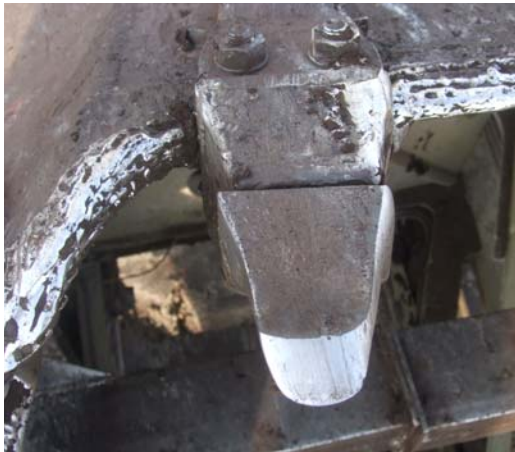
Слика П1.1 а) Облик и величина хабања постојећих једноделних резних зуба, Пример хабања резног дела „нулте“ серије модуларних резних зуба; б) леђна површина, ц) Хабање бочне стране
