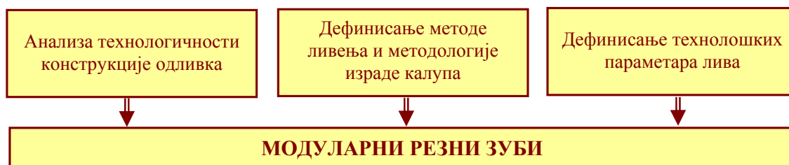
Слика 6.34 Основни захтеви при пројектовања технологије ливења модуларних резних елемената
