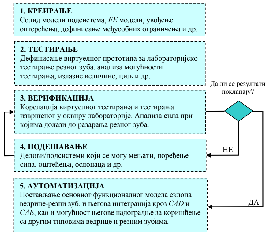
Слика 6.13 Шематски приказ развоја функционалног виртуелног прототипа [136]
