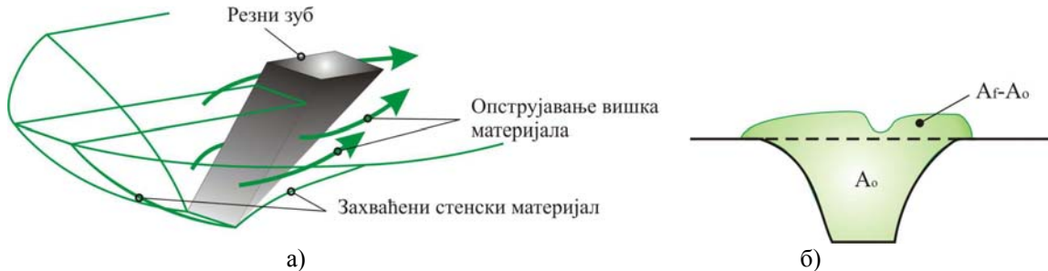
Слика 3.16 а) Кретање материјала око резног елемента, б) Попречни пресек разореног стенског материјала који је био у интеракцији са резним елементом
