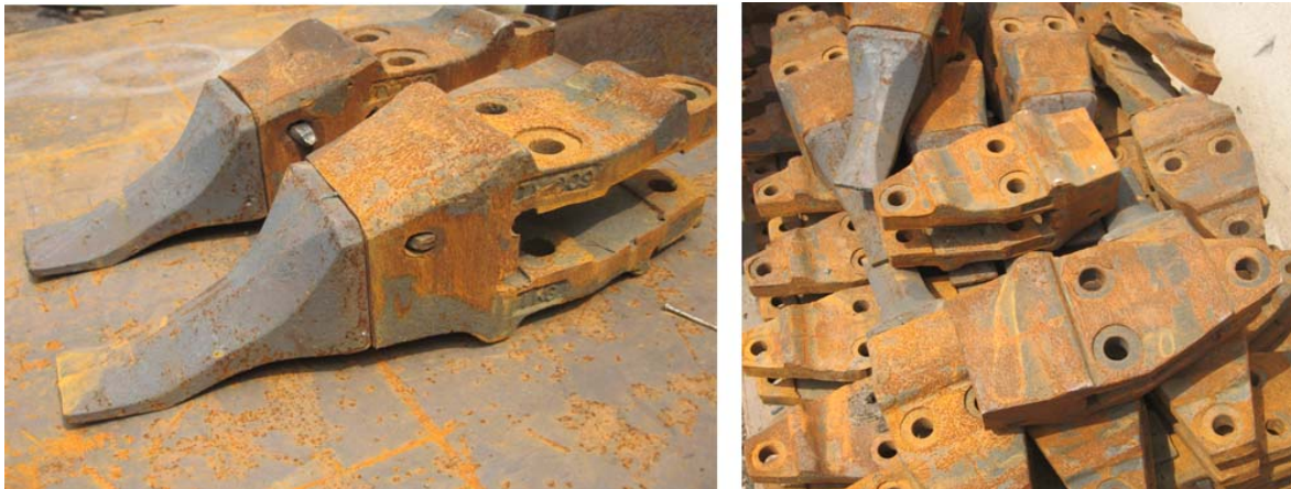
Слика 5.14 Одливена и монтирана пробна серија модуларних резних зуба
