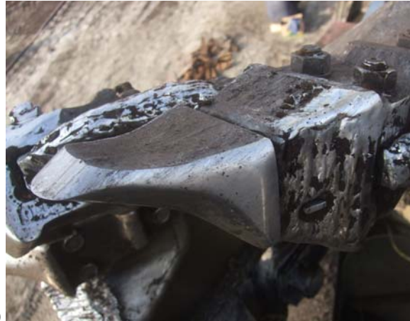
Слика П1.1 а) Облик и величина хабања постојећих једноделних резних зуба, Пример хабања резног дела „нулте“ серије модуларних резних зуба; б) леђна површина, ц) Хабање бочне стране
