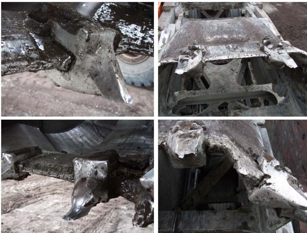
Слика 5.6 Постојеће стање хабања једноделних резних зуба на багеру ведричару ERS1000/20
