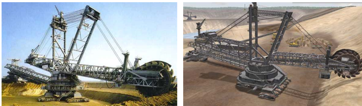
Слика 6.8 Основни концепт физичког и виртуелног прототипа роторног багера [135]
