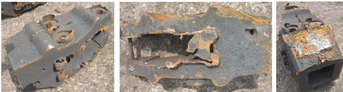
Слика 6.36 Примери неправилности одливака носача модуларног резног зуба
