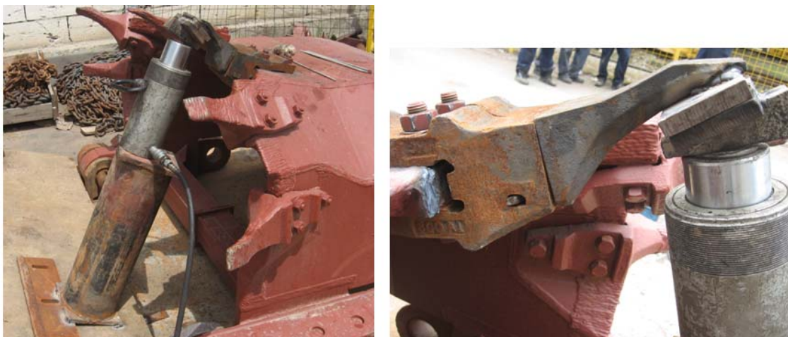
Слика 5.15 Статичко оптерећење модуларног зуба до границе разарања
