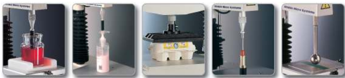
Slika 8. Različite sonde teksturometra
