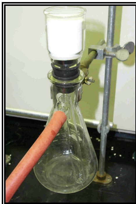
Slika 3.3 Aparatura za “dry-column flash” hromatografiju
