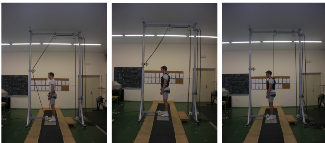
Slika 3. Šematski prikaz primenjenih opterećenja. (A) Elastične gume vuku na dole relativno konstantnom silom, simulirajući povećanje gravitacione komponente ( G ), (B) prsluk sa tegovima simulira povećanje i gravitacione i inercione komponente opterećenja ( G+I ), dok (C) kombinacija prsluka i elastičnih guma koje vuku na gore, simulira povećanje inercione komponente ( I ).
