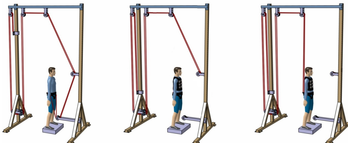
Slika 1. Šematski prikaz mogućnosti izolovanja komponenti opterećenja: gravitaciona komponenta (konstantno opterećenje na dole), gravitaciona + inerciona komponenta (prsluk-tegovi), inerciona komponenta (istovremena primena tegova i konstantnog rasterećenja).
