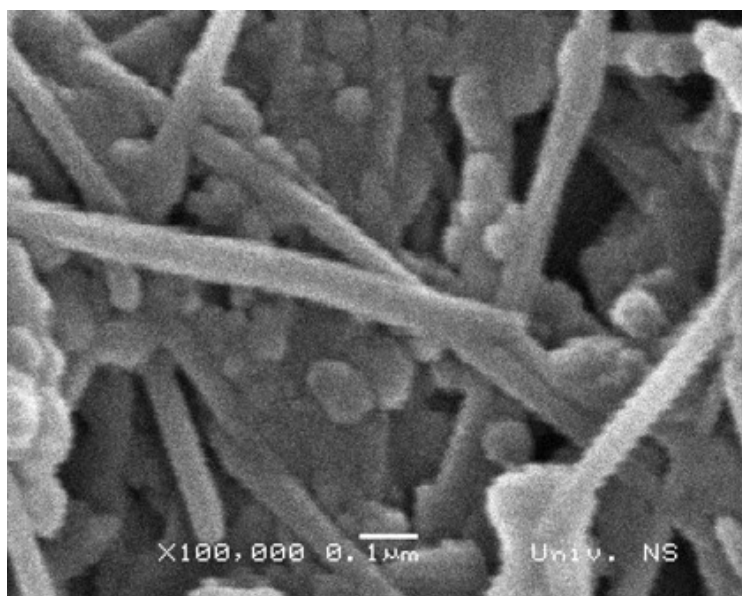
Slika 15. MWCNT nakon prečišćavanja polimerom PmPV.
