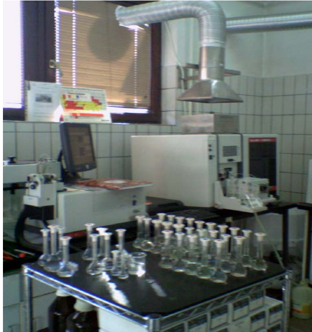
Slika 4. Konfiguracija atomskog apsorpcionog spektrofotometra Varian, SpektraAA 220, sa hidridnim generatorom VGA 77 grafitnom peći GTA 110 i autosemplerom (Institut za higijenu i tehnologiju mesa - Odeljenje za ispitivanje rezidua)
