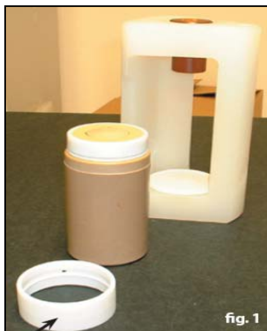
Slika 7. Izgled teflonske kivete i segmenta rotora za digestiju (Milestone Inc.)
