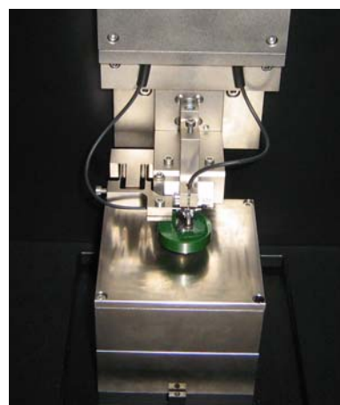
Slika 8.6. „CSM Nanotribometer Instrument“ nanotribometar „ball-on-flat“ kontaktne geometrije.
