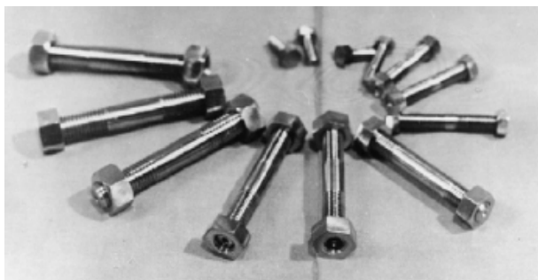
Slika 6.3. Zavrtnji i vijci izrađeni od legure titana podvrgnute SPD procesu [176].
