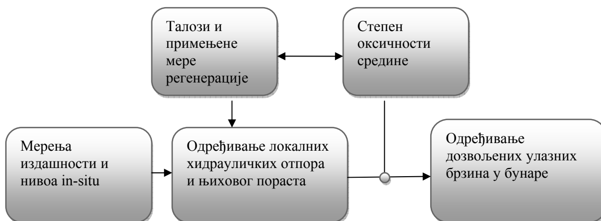
Слика 3.5: Концепт примењен при одређивању дозвољених улазних брзина у бунаре
