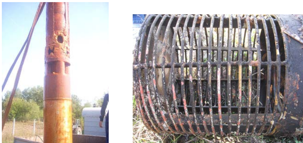
Слика 6.6: Корпа пумпе прекривена талогом на изворишту Трновче (фото: Миолски 2010) у односу на корпу пумпе извађену после 25 година рада из бунара Еб-2 на изворишту Кључ (фото: Мајкић 2010)
