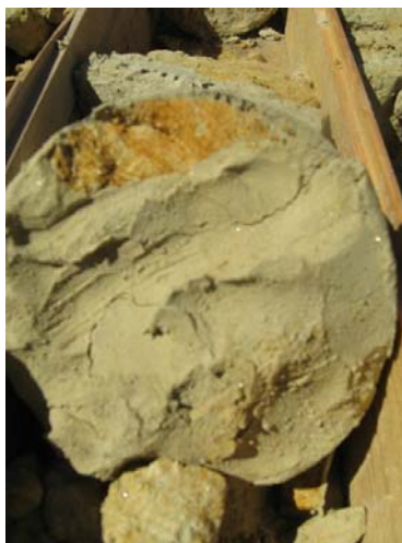
Слика 4.3.9: Узорак ситнозрно-алевритичних пескова из подине водоносног слоја (серије 5P) набушеног испод корита Дунава у профилу Ковин на дубини од 8,5-9,8 m (фото: Мајкић 2012)
