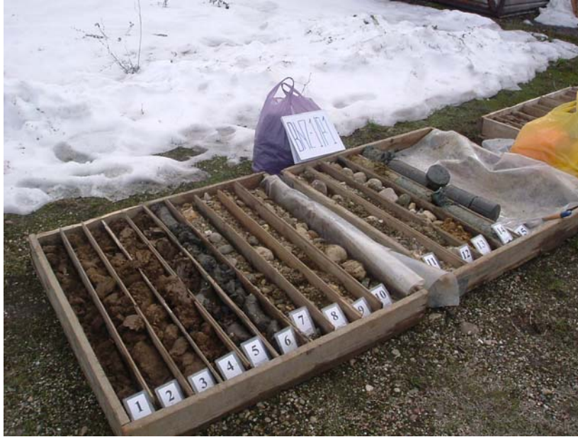
Слика 4.1.10: Набушени слојеви током извођења блиског пијезометра Vnz-1/P-1 на изворишту Трновче (фото: Мајкић 2010)
