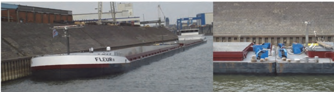
Слика 4.4 – Самоходни теретни брод дужине 171 метар (самохотка + припадајућа баржа)
