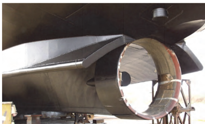
Слика 7.7 – Форма крме једнопропелерне самохотке [9]
