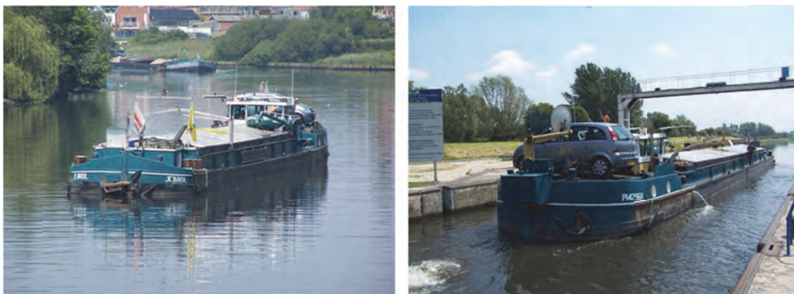
Слика 2.6 – Брод класе Peniche ; димензије: 39x5.05x2.40; носивост: 354 тоне; година градње: 1961; уграђена снага: 242 kW
