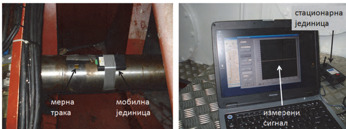
Слика 5.3 – Мерење апсорпције снаге на самохотки „Transferium”
