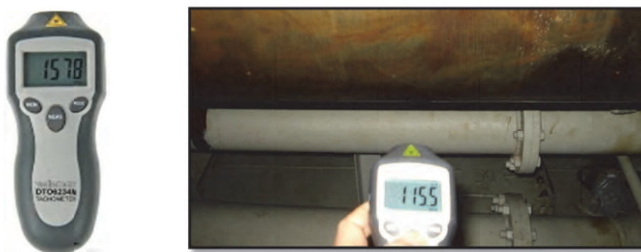
Слика 5.1 – Мерење броја обртаја пропелерског вратила
